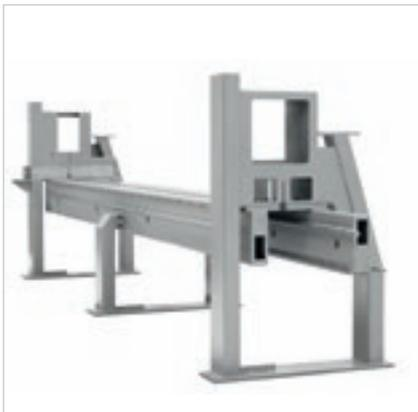
Perfekte Stabilität dank der festen Stahlstruktur des **Maschinenbetts**, das durch stabile Abstützungen getragen wird. Die Gleitschienen des Sägewagen sind auf dem gleichen Träger positioniert. Dadurch ist deren perfekte Parallelität und Geradheit gesichert.
