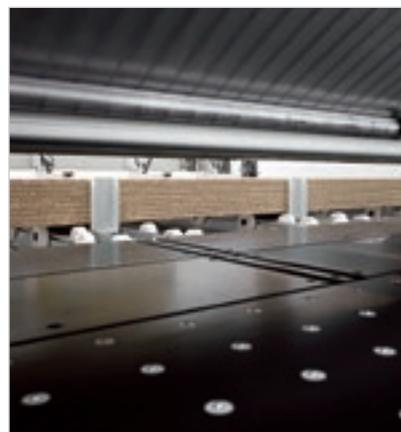
**Leistungsfähige Frontausrichter** richten automatisch das Plattenpaket gegen die Spannzangen des Schiebers aus.
