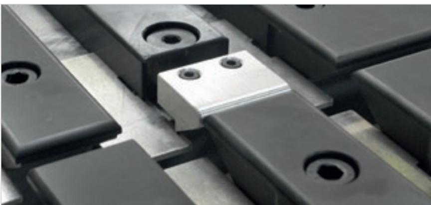
**Verschlussystem der Schnittlinie**, um das Herabfallen der Längsabschnitte zu vermeiden.
