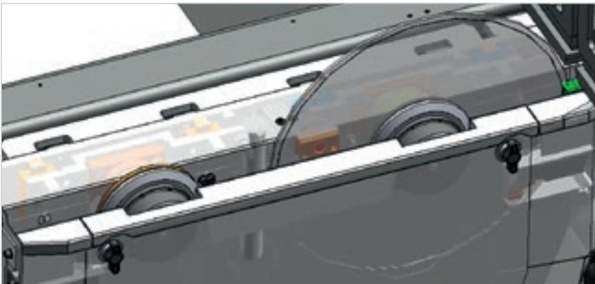
Die **Deflexion** kontrolliert die Position und die Drehzahl des Sägeblatts und wirkt auf die Vorschubgeschwindigkeit. Maximale Schnittqualität, längere Lebensdauer des Sägeblatts und Reduzierung der Wartungskosten.
