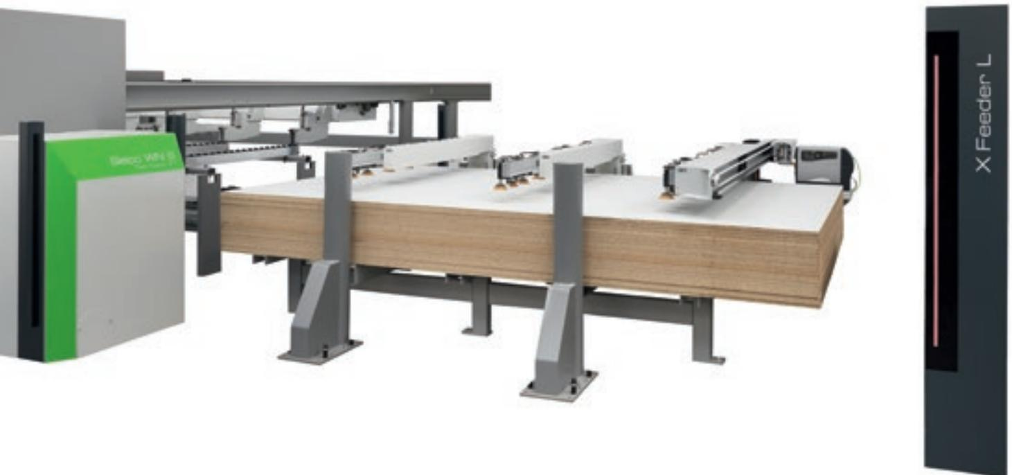
**Automatisches Erkennen der Position des Plattenstapels, für eine korrekte und genaue Etikettierung.**
