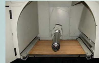
Werkstück-Andruckplatte zum Schneiden kurzer Teile
