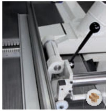
Anschlag rollengeführt (selbstständiger Höhenausgleich), Ein-Hand-Bedienung
