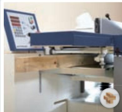
*Praktisches Handling kurzer Werkstücke durch Ansatztische am Ein- und Auslauf*
