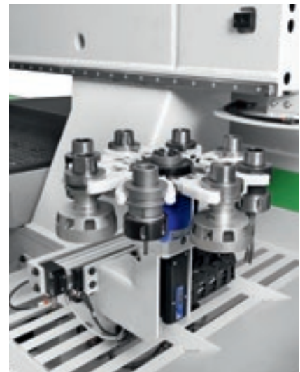
Revolverwechsler mit 8 Plätzen, fest mit dem Querträger der Maschine verbunden.
