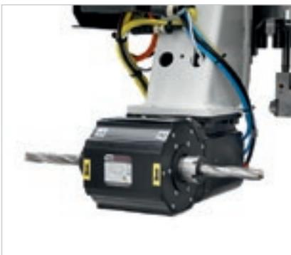
**Horizontaler Motor mit 2 Ausgängen** für Schlüsselaussparungen und horizontale Bearbeitungen.
