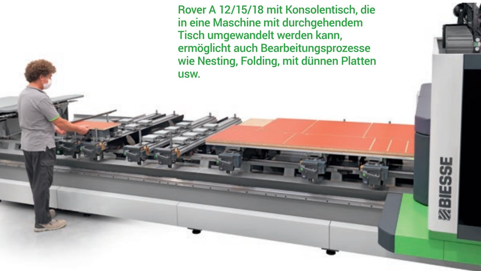
Das Schneiden im Nesting-Modus ermöglicht es, ausgehend von einer großformatigen Platte, zugeschnittene Maßteile zu erhalten. Die Einzelteile können im gegenüberliegenden Bearbeitungsbereich mit allen Bearbeitungen fertiggestellt werden, die nicht auf einem durchgehenden Arbeitstisch ausführbar sind (horizontale Bohrungen, Bearbeitungen mit Hinterschneidung usw).
