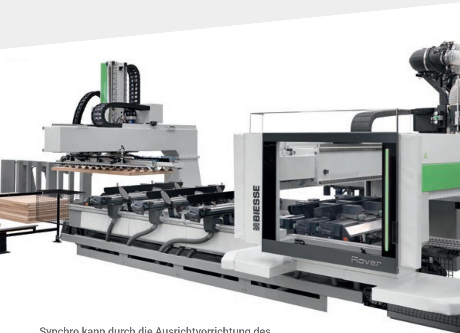
Synchro kann durch die Ausrichtvorrichtung des Stapels und den Vorpositionierungszyklus, der im Hintergrund während die CNC Bearbeitung stattfindet, Platten unterschiedlicher Dimensionen verarbeiten.
