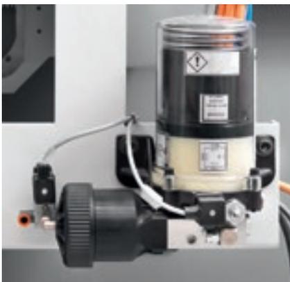
Automatische Schmierung Bohrkopf BHZ 29 2L.
