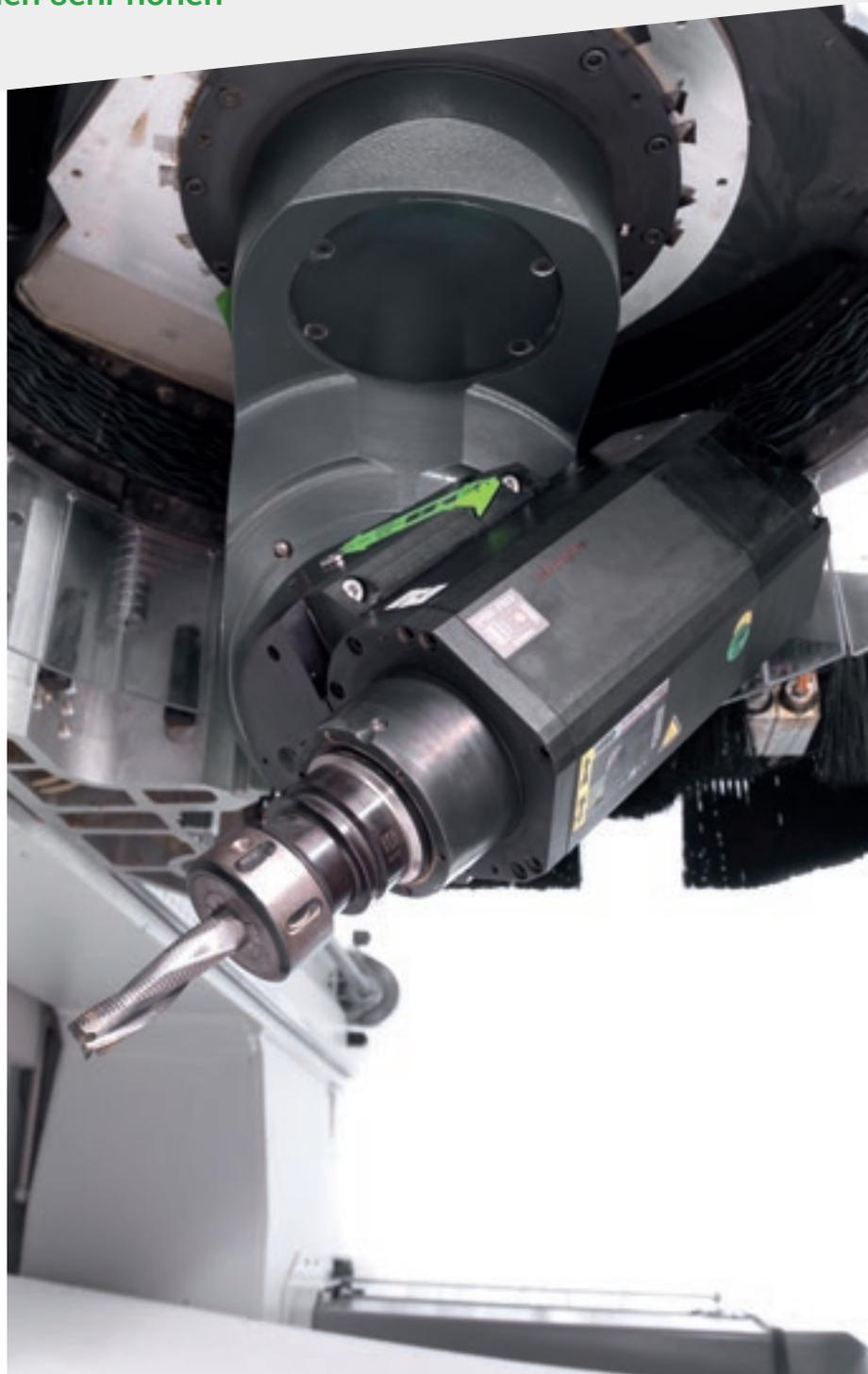
Die 5-Achsen-Einheit mit 16,5 kW und die Elekterspindel mit 19,2 kW, beide mit 6 großformatigen Keramiklagern, gewährleisten hohen Abtrag und maximale Feinbearbeitungsqualität.
